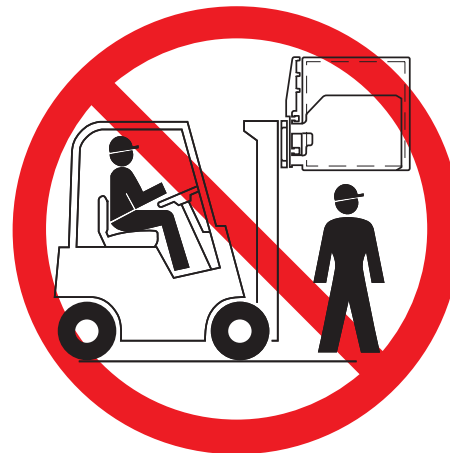
禁止货物下站人 No standing under load
