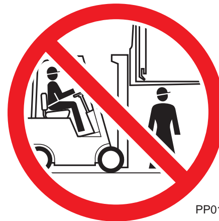
禁止货物下站人 No standing under load
